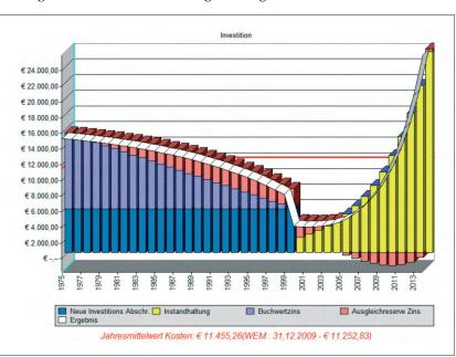
Bild 1: Prinzip der Lebensdauer-Kostenanalyse mittels LCC
